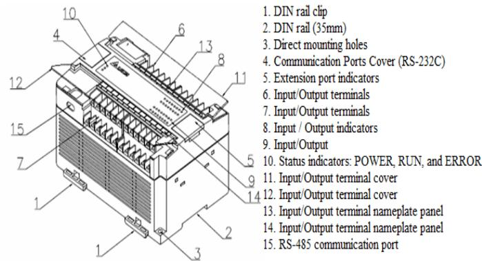
**Fig.7. PLC Pin diagram**
